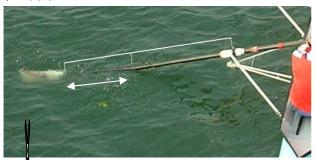
↑さく沈んだシャフトは、艇の進行方向に動き大きな抵抗となる。 水がブレードを乗り越え艇尾へ流れていれば抵抗となっている。
